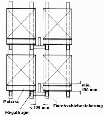
Abb. 8a: Durchschiebesicherung
