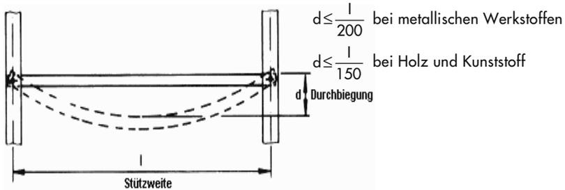
**Abb. 1:** Höchstzulässige Durchbiegung der tragenden Elemente von Lagereinrichtungen
