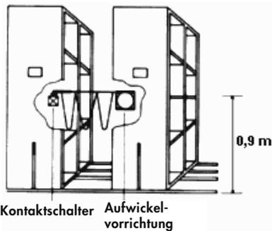
Abb. 15: Beispiel einer Seilzugsicherung bei geschlossenem Steuerstromkreis
